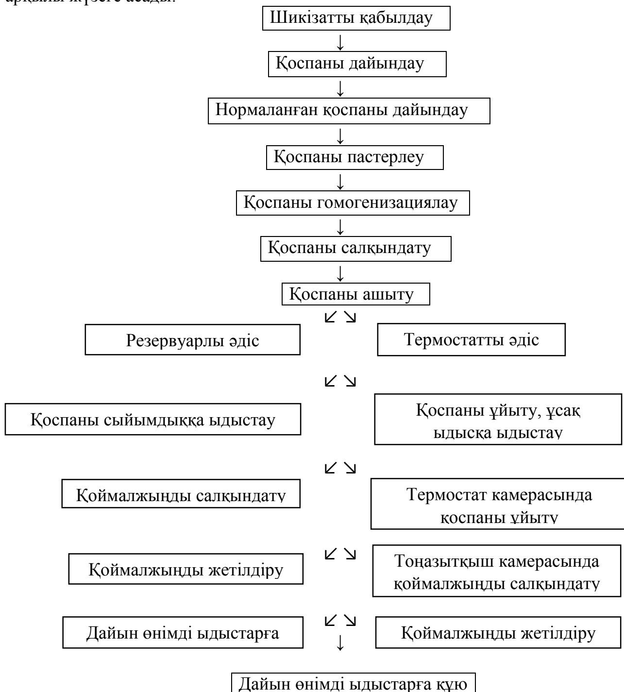
1 Сурет – Сүтқышқылды сусындарды өндірудің технологиялық схемасы
